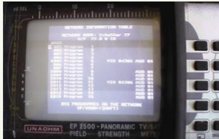
迭戈的卫星仪表上显示他接收到的 ECHOSTAR 6 A 上一个转发器的 NIT 目录。
